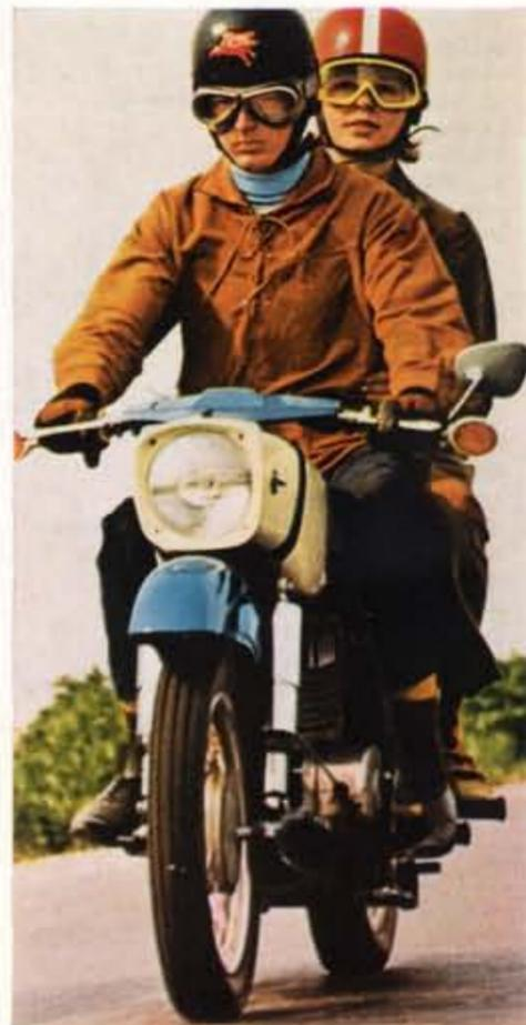
Hervorragend sind die Beschleunigungswerte: Aus dem Stand auf 80 km/h in 12 bzw. 9 Sekunden! Imponierend wirkt der großflächig verrippte und geräuschisolierende Breitrippenzylinder, der für die notwendige Temperaturabsenkung und absolute Vollgasfestigkeit sorgt. Bemerkenswert ist die weiche Kupplung. Der Zentralschwimmer-Startvergaser ist lageunempfindlich und ermöglicht Kaltstart ohne Tupfen. Verschleißmindernd wirkt die Luftzufuhr aus der staubfreien Zone am Steuerkopf über Trockenluftfilter.
