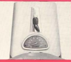
Lenkerabdeckung schützi Hebei und Bowdenzüge. Scheinwerfer verstellbar, 170 mm Lichtaustritt, asymmetrisches Abblendlicht, neuer Segmenttache mit Kontrolleuchten.
